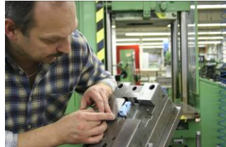
Herstellung der Stahlformen
